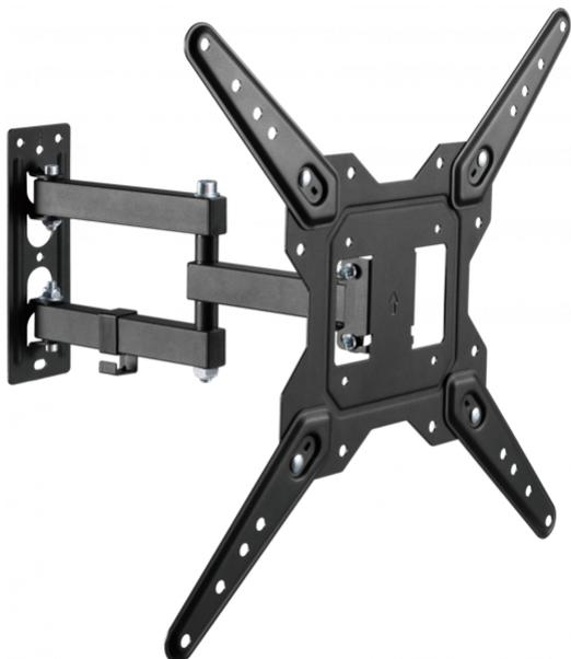
La gama de soportes de montaje mural para pantallas planas de Vision es resistente y flexible. El VFM-WA4X4/3 se adapta a cualquier pantalla plana LCD o LED que incorpore orificios de montaje traseros con una separación entre ellos de 400 x 400 mm.
