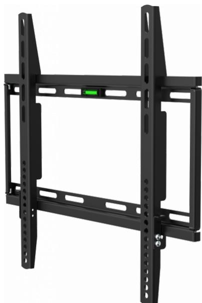
La gama de soportes de pared para pantallas planas de Vision es flexible e incluye todo lo necesario para fijar la pantalla a la pared. El VFM-4X4V es apto para cualquier pantalla plana LCD o LED que incorpore orificios de montaje traseros con una separación horizontal y vertical entre ellos de 400 mm y 400 mm, respectivamente. Su sencillo diseño está concebido para aplicaciones que exigen un precio asequible.
