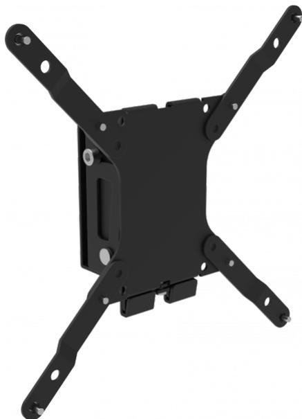
Les supports d'écran plat Vision (VFM) sont solides et simples à installer. Ce support est adapté à tous les écrans plats au format de montage VESA standard, jusqu'au VESA200, dont les trous sont écartés de 200 x 200 mm. Il accepte également les téléviseurs dont les points de montage sont écartés de 200 mm en largeur et 100 mm en hauteur.
