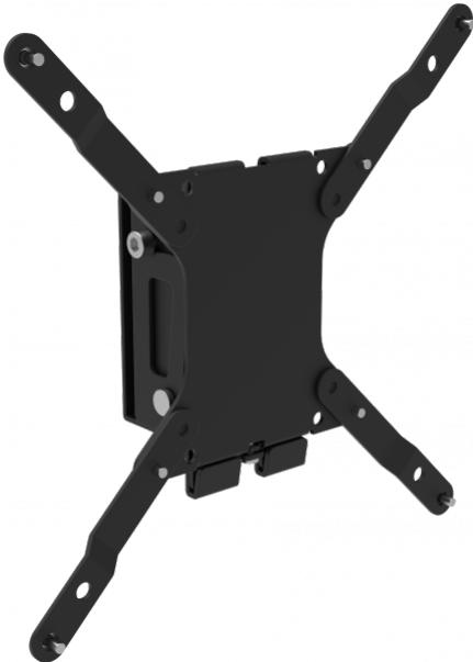
Los soportes para pantallas planas de Vision (VFM) son resistentes y fáciles de instalar. Este soporte se adapta a cualquier pantalla plana que incorpore un patrón de montaje VESA estándar hasta VESA 200 como máximo, con una separación horizontal y vertical entre orificios de 200 mm y 200 mm, respectivamente. También es apto para televisores con una separación horizontal y vertical entre orificios de 200 mm y 100 mm, respectivamente.
