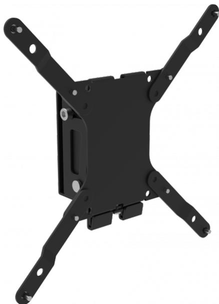
Die Flachbildschirmhalterungen (VFM) von Vision sind robust und einfach zu montieren. Diese Halterung eignet sich für alle Flachbildschirme mit einer standardmäßigen VESA Befestigungskonfiguration bis VESA 200, die Montagepunkte mit einem Höhenabstand von 200 x 200 mm besitzt. An ihr können auch Fernseher befestigt werden, die Montagepunkte mit 200 mm x 100 mm (Breite x Höhe) besitzen.
