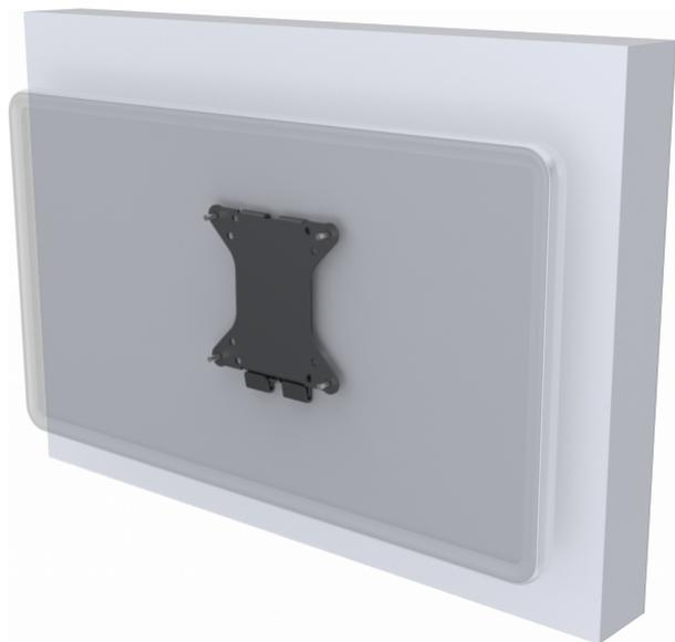
Questo **sistema di montaggio Vision per schermo piatto** è robusto e semplice. È adatto per qualsiasi schermo piatto LCD o schermo a LED con configurazione di montaggio standard VESA 100, con fori distanziati di 100 x 100 mm in altezza. La maggior parte dei monitor da scrivania di piccole e medie dimensioni utilizza questa configurazione di montaggio.
