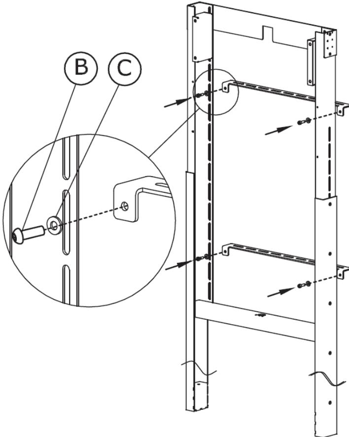
4. [SE FIXAR À PAREDE] FIXE OS SUPORTES DE PAREDE Certifique-se de que os suportes estão localizados sobre as estruturas de suporte de carga. O alcance dos suportes é ajustável para permitir que a calha passe atrás, etc.
