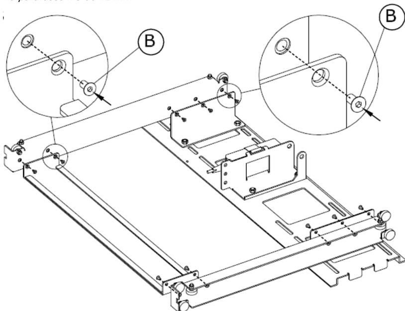
9. DESCER A MONTAGEM DA ESTRUTURA MÓVEL ATÉ AO LUGAR CERTO Posicione o motor, tal como indicado, e desça a estrutura móvel até à marca.
