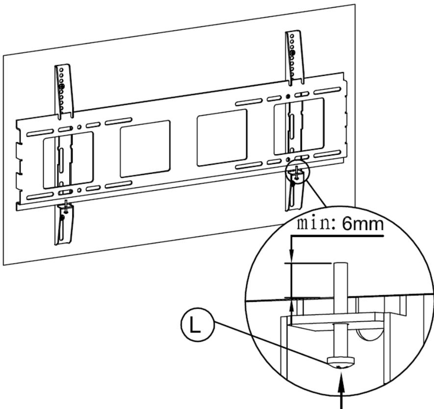
14. COLAR O LIMITADOR NA PARTE SUPERIOR DO ECRÃ PLANO Faça um teste para garantir que o motor para ANTES de o ecrã plano tocar no teto.
