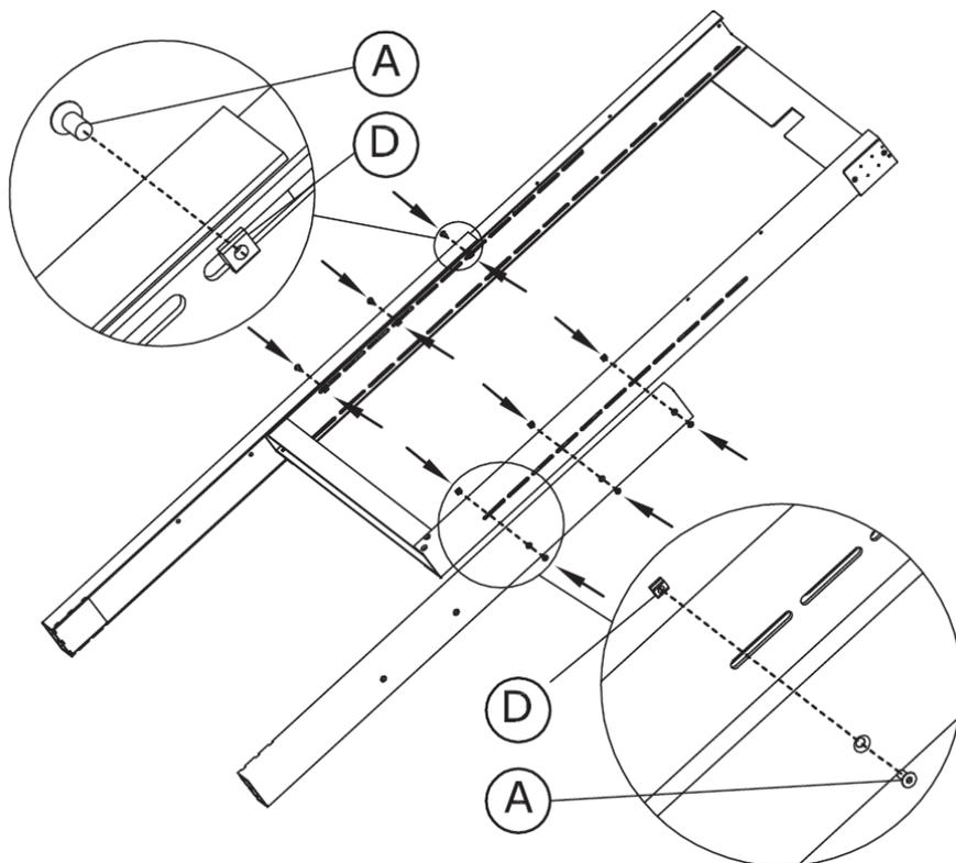
3. [SE FIXAR À PAREDE] FIXE AS GUIAS DO SUPORTE DE PAREDE Certifique-se de que os suportes estão fixados a uma altura correta, para segurar as estruturas de suporte de carga.
