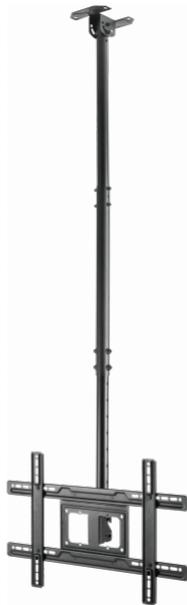
La gama VFM-C (siglas que identifican los soportes de techo para pantallas planas de Vision) de Vision es funcional y flexible. Este soporte es apto para cualquier pantalla plana que incorpore orificios de montaje traseros con una separación horizontal y vertical entre ellos de hasta 600 mm y 400 mm respectivamente. Es un soporte de techo verdaderamente universal.
