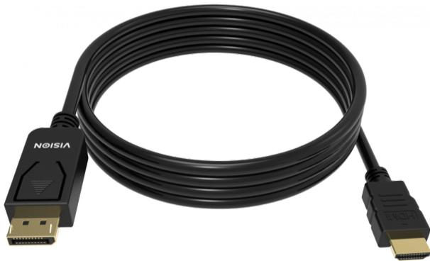
Gestattet das Anschließen von PCs mit Dual-Mode-DisplayPort (DP++) an Anzeigegeräte mit HDMI-Eingang. NICHT BIDIREKTIONAL. KEINE KONVERTIERUNG VON HDMI ZU DP.
