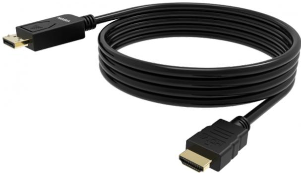
Gestattet das Anschließen von PCs mit Dual-Mode-DisplayPort (DP++) an Anzeigegeräte mit HDMI-Eingang. NICHT BIDIREKTIONAL. KEINE KONVERTIERUNG VON HDMI ZU DP.
