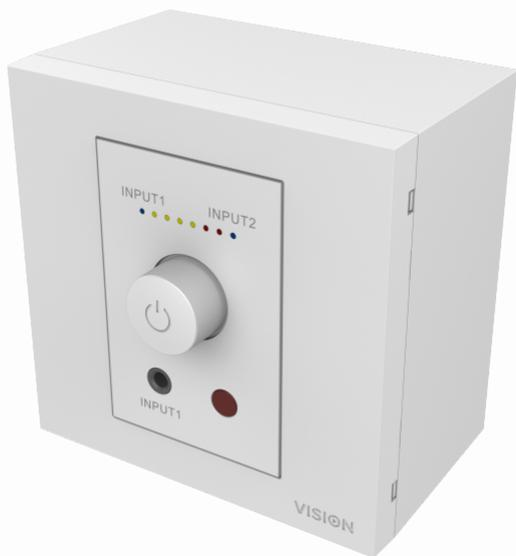
Al utilizar la tecnología más avanzada de chips para amplificadores digitales de baja impedancia, el nuevo módulo de amplificador Techconnect ofrece una enorme potencia en sus 2 salidas de 25 W RMS (a 8 ohmios) con un tamaño reducido que encaja en el espacio de un módulo doble. Es idóneo para espacios de reuniones, museos y salas de presentación.
