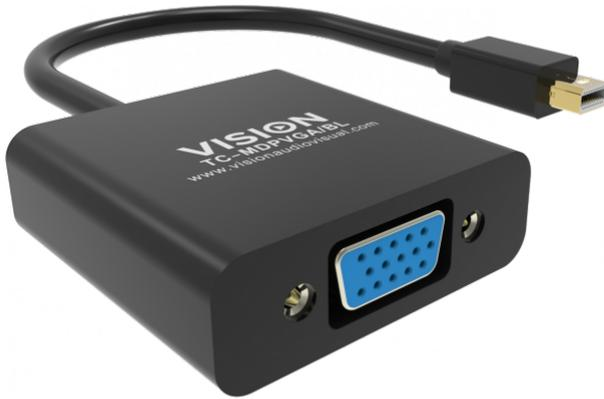
Si inserisce in una porta Mini-DisplayPort (nota anche come Thunderbolt) e fornisce una presa VGA. Il circuito attivo converte il segnale digitale in segnale analogico VGA per display non dotati di un ingresso digitale.
