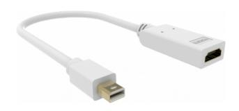
Si inserisce in una porta Mini-DisplayPort (nota anche come Thunderbolt) e fornisce una presa HDMI standard. Il circuito attivo consente la connessione di PC dotati o meno di porta DisplayPort in modalità doppia (DP++) a display con ingressi HDMI.
