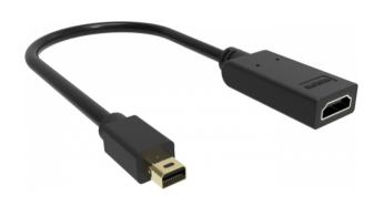
Anschluss an Mini-DisplayPort (auch bekannt als Thunderbolt), mit HDMI-Buchse in voller Größe. Aktive Schaltung gestattet das Anschließen von PCs mit oder ohne Dual-Mode-DisplayPort (DP++) an Anzeigegeräte mit HDMI-Eingang.
