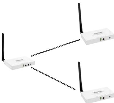
È consentito l'utilizzo simultaneo di 10 Tx ed è pertanto possibile formare 10 sistemi di distribuzione discreti o una combinazione di sistemi di distribuzione, switching e a matrice che funzionano contemporaneamente.
