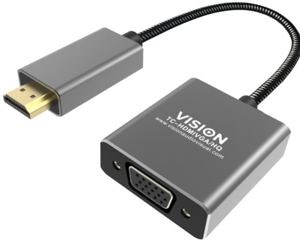
Lässt sich an den HDMI-Anschluss eines Laptops anschließen. Konvertiert digitale HDMI-Signale in analoge VGA-Signale. Ideal, wenn Sie Präsentationen in einer älteren Präsentationsumgebung durchführen, in der es nur ein VGA-Kabel zwischen dem Pult und dem Projektor gibt.
