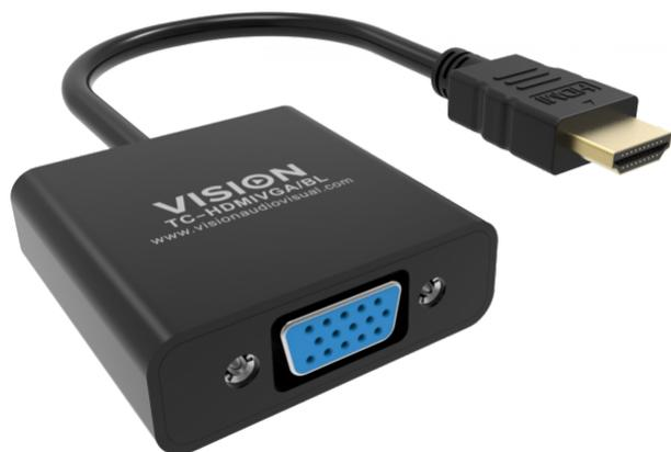
Si collega alla porta HDMI del laptop. Converte il segnale digitale HDMI in segnale analogico VGA. Ideale per tenere presentazioni su apparecchiature obsolete che dispongono unicamente di collegamento via cavo VGA tra il leggio e il proiettore.
