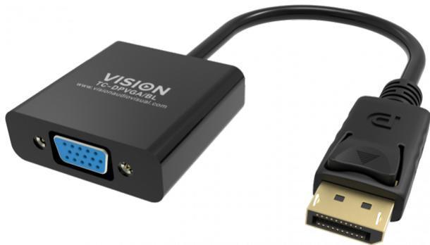
Liga-se à entrada DisplayPort do portátil e tem uma tomada VGA. O circuito ativo converte o sinal digital em sinal VGA analógico, para dispositivos de visualização que não possuem entrada digital.
