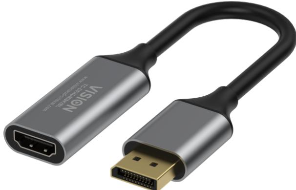
Se conecta al DisplayPort y dispone de toma HDMI de tamaño completo. El circuito activo permite conectar PC con o sin DisplayPort de modo dual (DP++) a pantallas con entrada HDMI. NO BIDIRECCIONAL. NO CONVIERTE HDMI EN DP.
