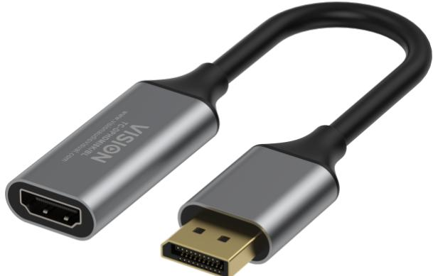
Lässt sich an DisplayPort-Anschlüsse anschließen und bietet eine HDMI-Buchse in voller Größe. Aktive Schaltung gestattet das Anschließen von PCs mit oder ohne Dual-Mode-DisplayPort (DP++) an Anzeigegeräte mit HDMI-Eingang. NICHT BIDIREKTIONAL. KEINE KONVERTIERUNG VON HDMI ZU DP.
