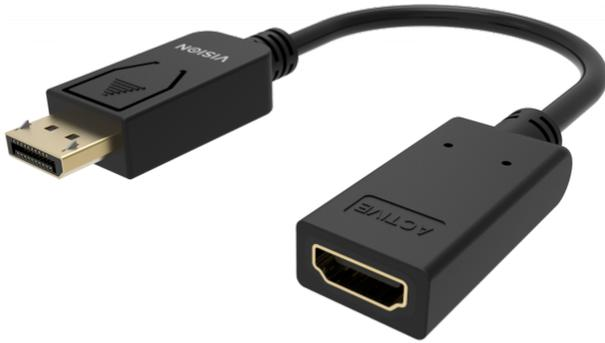
Si inserisce in una porta DisplayPort e fornisce una presa HDMI standard. Il circuito attivo consente la connessione di PC dotati o meno di porta DisplayPort in modalità doppia (DP++) a display con ingressi HDMI. NON BIDIREZIONALE. NON CONVERTE HDMI IN DP.
