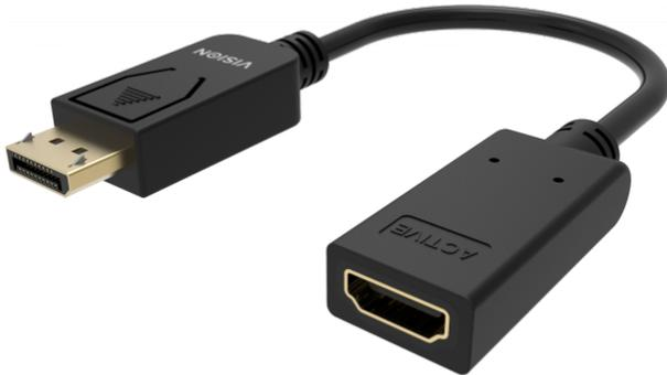
Muni d'une prise HDMI de taille standard, ce convertisseur se branche sur une prise DisplayPort. Le circuit actif permet de brancher des ordinateurs munis ou non de sorties DisplayPort « double mode » (DP++) sur des dispositifs d'affichage à entrées HDMI. NON BIDIRECTIONNEL. NE CONVERTIT PAS LE HDMI EN DP.
