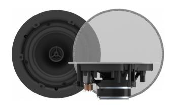
Los altavoces de techo CS-1800 tienen un diseño de dos vías. Utilizan el vano del techo como un bafle infinito, lo que permite la excursión del driver sin amortiguamiento, todo lo cual se suma a un sonido intenso y detallado. El driver principal es un cono de 6,5" de polipropileno complementado con un tweeter avanzado de 0,5". Estos altavoces de baja impedancia no provocan pérdidas de la banda de frecuencias como lo hacen los altavoces de línea de 100 / 70 V.
